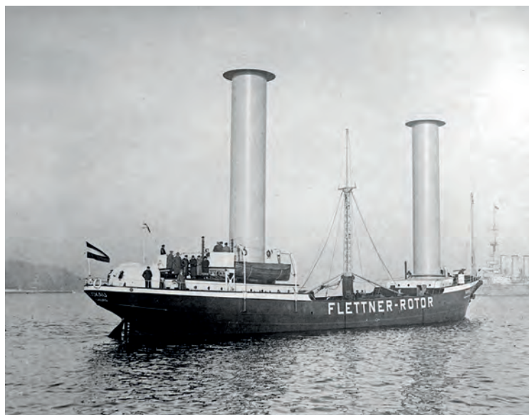
El Buckau , una goleta de tres palos de 54m de eslora, cuya arboladura fue sustituida en 1924 por rotores Flettner, que fueron su única forma de propulsión por unos dos años hasta que, en 1926, los rotores fueron eliminados y se dotó la nave de hélices impulsadas por motores diésel.
