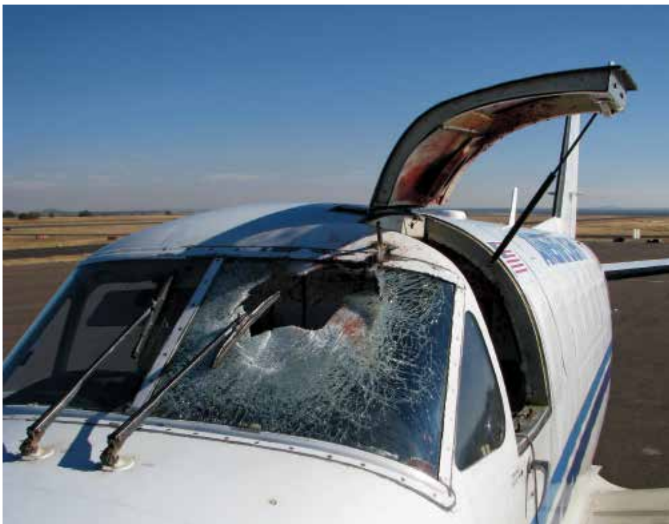
Resultado del impacto de una o más aves en el parabrisas de un avión en vuelo. El incidente ocurrió el 4 de noviembre de 2009 en Arizona. El piloto logró aterrizar con heridas faciales menores y un hombro amoretonado. Foto Aeropuerto Regional de Show Low, Arizona.
