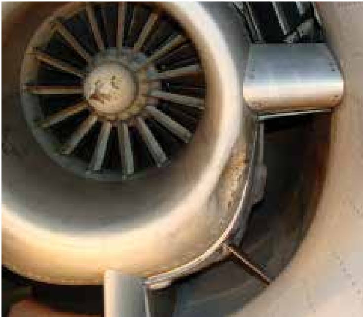
Arriba: daños producidos a una turbina de avión en el aeródromo de Campo de Mayo por un ave de tamaño medio, el carpintero campestre ( Colaptes campestris ). Abajo: bandada de estorninos ( Sturnus vulgaris ) volando en un aeropuerto europeo en el momento en que despegaba un Boeing 737-900 de Turkish Airlines.
