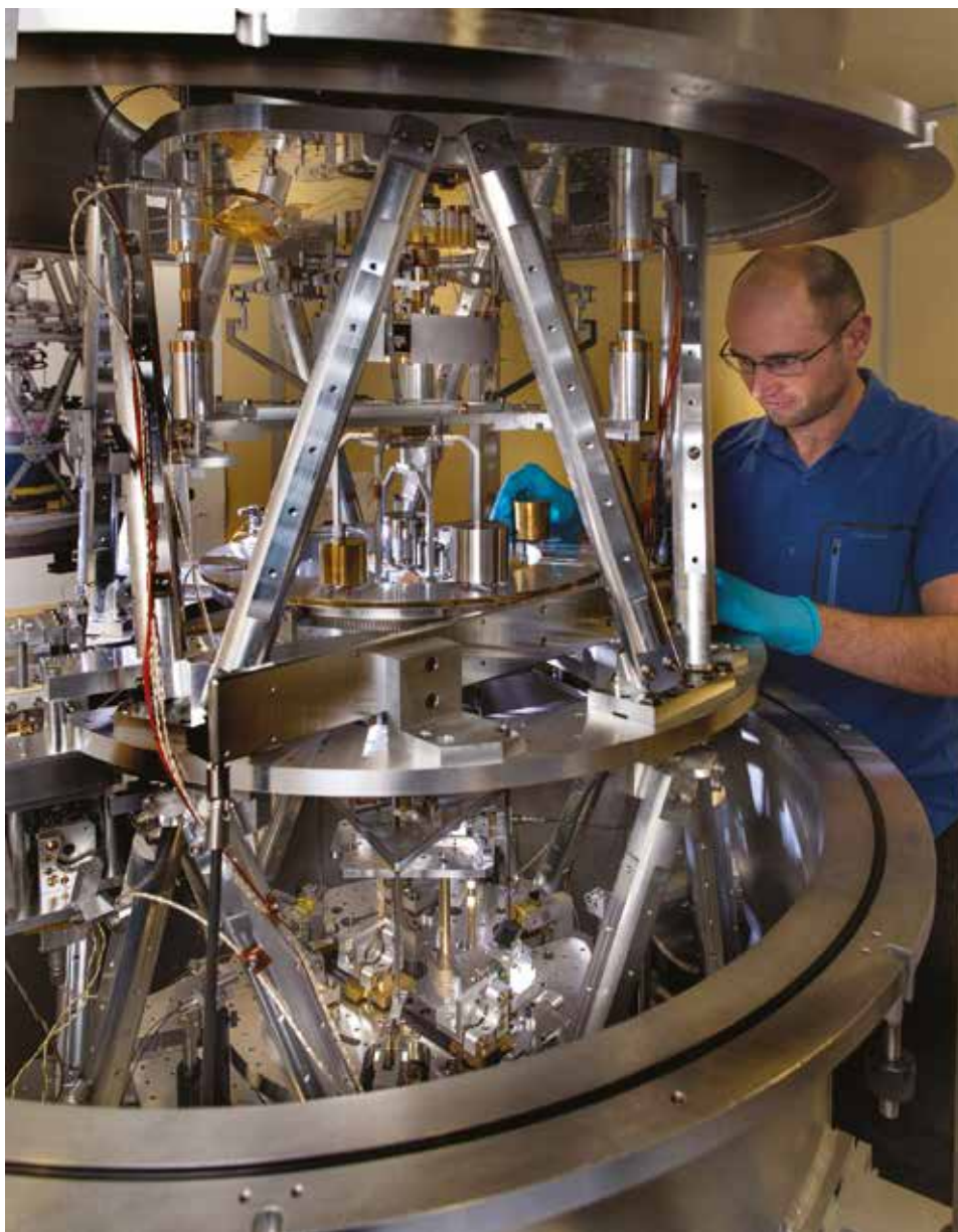
Una balanza de Kibble. A pesar de tratarse de un instrumento altamente complejo y delicado, diversos grupos de investigación lograron construir varias en distintos países. Como consecuencia, ya no se depende más de una única pesa patrón. Foto BIPM
