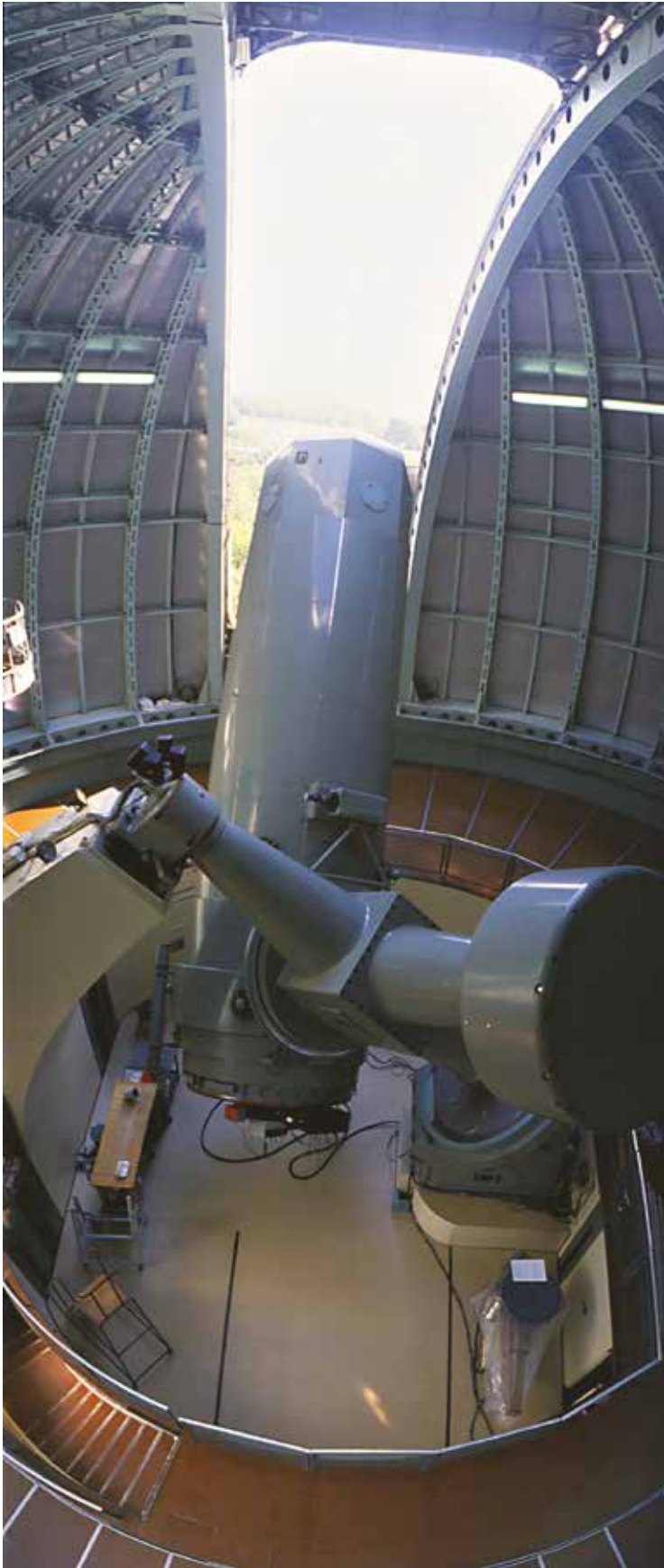
Telescopio de 1,93m del observatorio de la Alta Provenza, donde está instalado el espectrógrafo SOPHIE , con el que se detectó el exoplaneta Gliese 411b. CNRS/OHP
