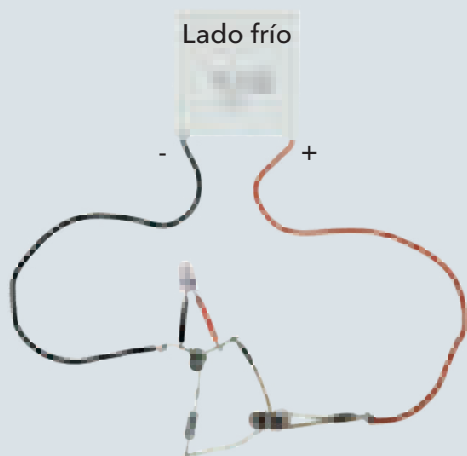
Figura 2. Circuito 'ladrón de joules' que permite encender un LED mediante una celda termoeléctrica (Peltier). Al generar electricidad, el cable rojo del Peltier es el positivo si la cara más fría es la que tiene la etiqueta (en este caso 'SP1848').
