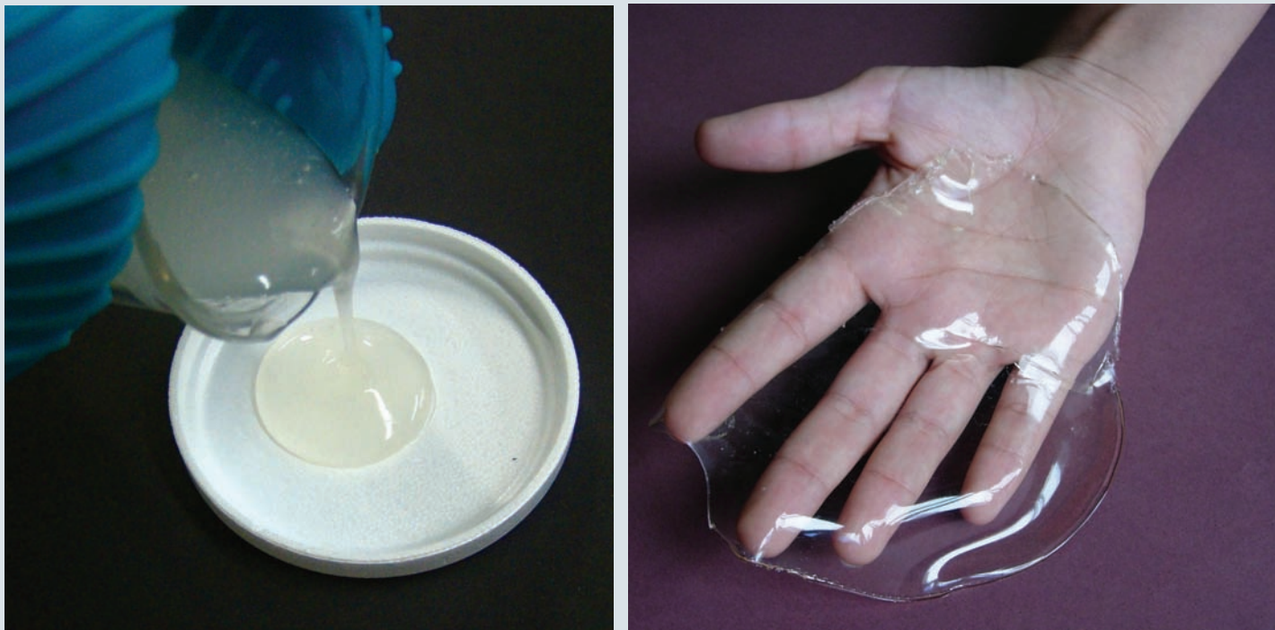
Figura 3. Bioplástico flexible de almidón. Vertido de la mezcla en el molde (izquierda) y producto final (bioplástico flexible) terminado.
