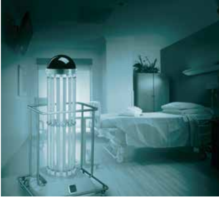
Equipo robótico de desinfección hospitalaria por luz ultravioleta en acción. Nótese la ausencia de personal durante su uso.
