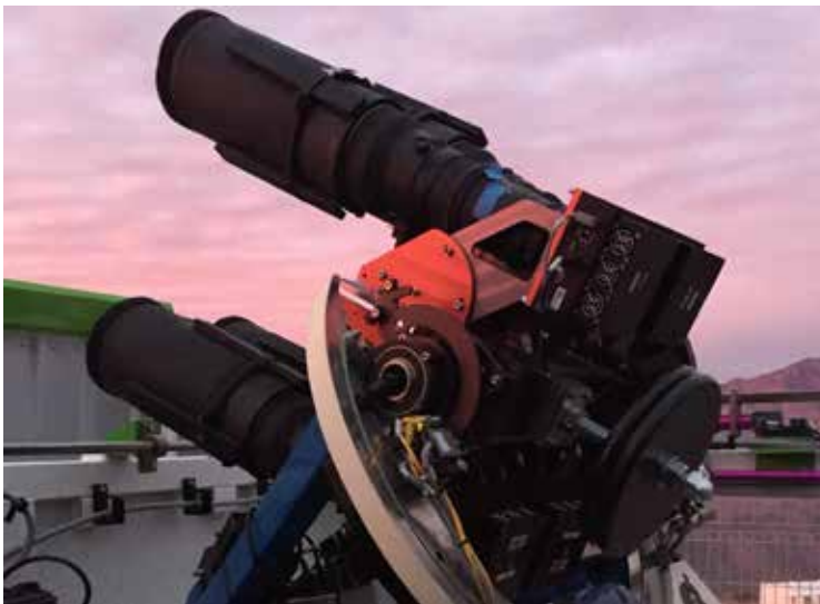
Conjunto de cuatro telescopios robóticos de 14cm de diámetro ubicados en el observatorio Cerro Tololo (Chile) como parte del proyecto ASASSN para descubrir supernovas y otros eventos transitorios. Imagen Tom Holoien, users.obs.carnegiescience.edu/tholoien/
