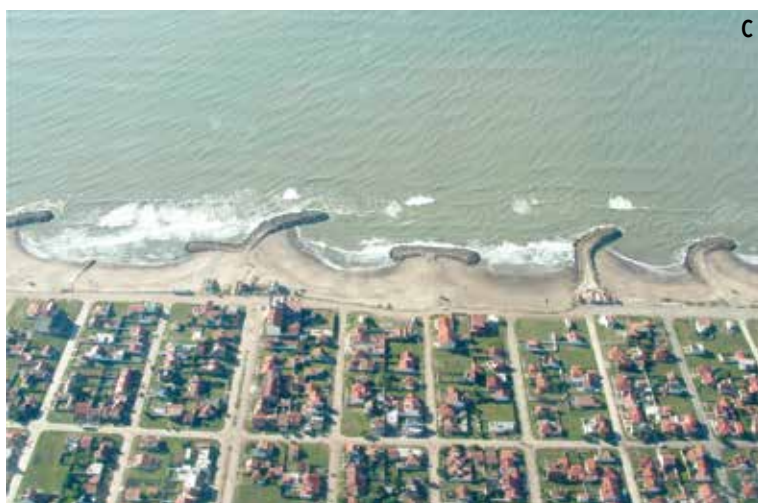
A. Croquis de la costa de Mar del Plata a la altura del puerto. Construido el puerto de Mar del Plata, la obstrucción de la deriva litoral originó erosión de las playas hacia el norte a medida que disminuía el transporte litoral. B. Los espigones perpendiculares colapsaban en la punta que enfrenta las olas. C. En muchos casos se los prolongó curvándolos como pedraplenes.
