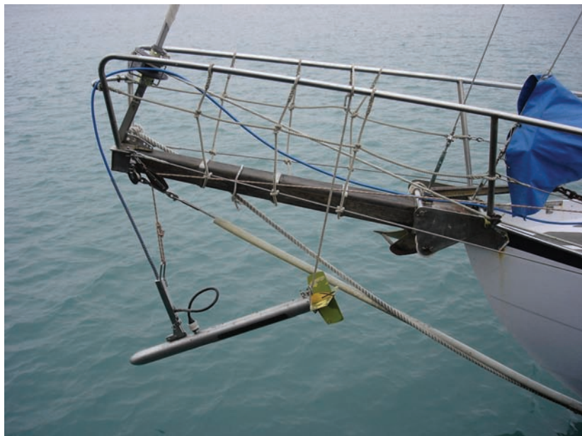
El sonar de barrido lateral es uno de los elementos habitualmente utilizados en la búsqueda de restos arqueológicos subacuáticos. Suele operarse remolcado desde una embarcación, y permite localizar elementos que sobresalen del lecho marino. Foto C Murray
