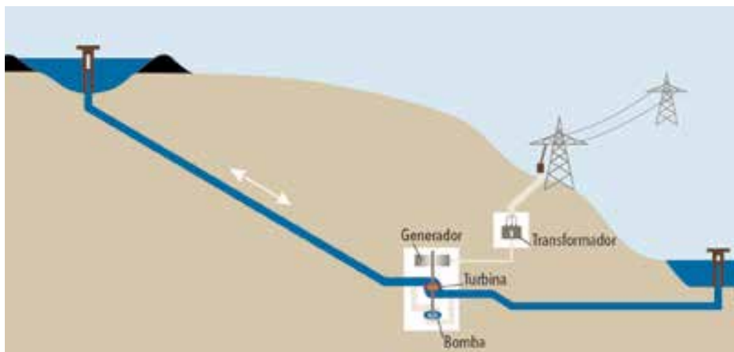
Figura 3. Esquema de una hipotética operación de almacenamiento por bombeo: cuando se genera más electricidad que la demandada, se emplea el sobrante para bombear agua del reservorio inferior (derecha) al superior; cuando se necesita más de lo que se produce, el agua antes elevada, que se deja caer por gravedad, genera electricidad que se vuelve a la red.
