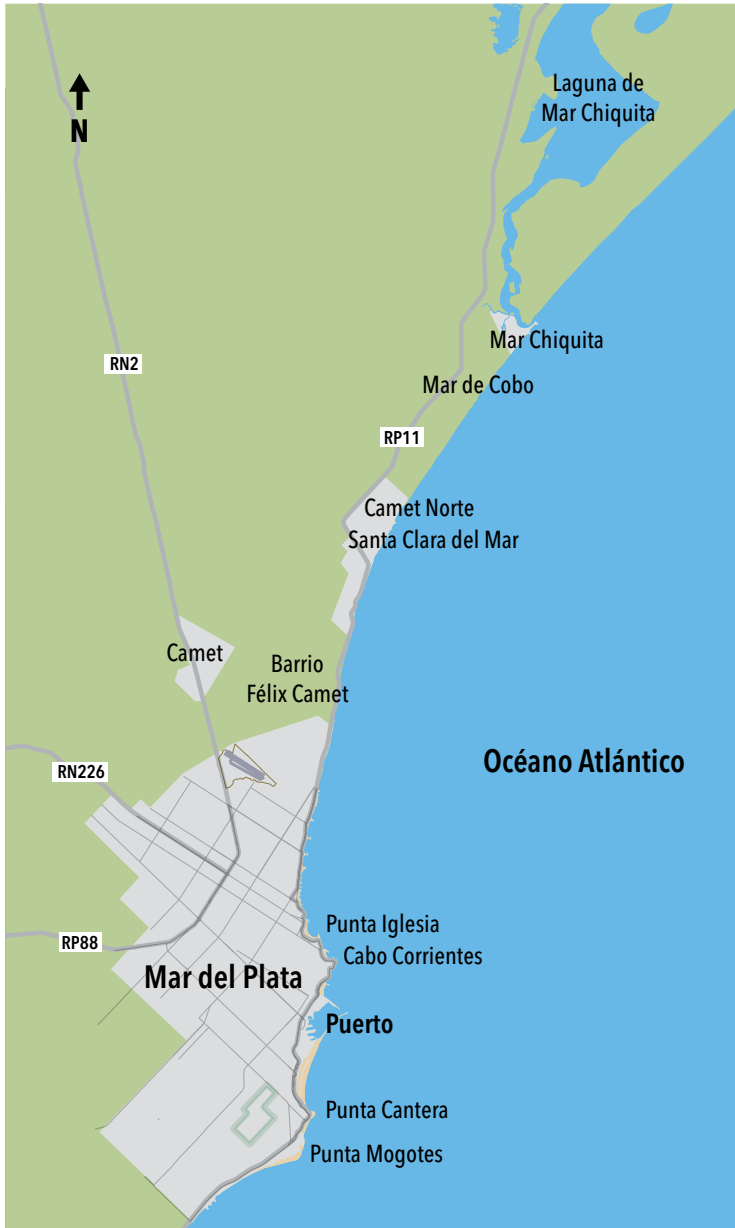
Sector de costa afectado a partir de 1911, después de la construcción del puerto de Mar del Plata. Hacia el norte de la obra, predominaron los procesos de erosión marina; hacia el sur, los de acumulación.
